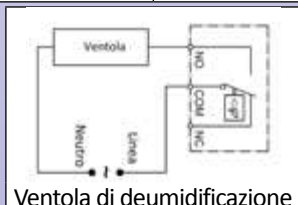
Ventola di deumidificazione
