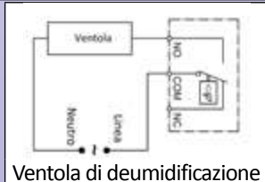
Ventola di deumidificazione
